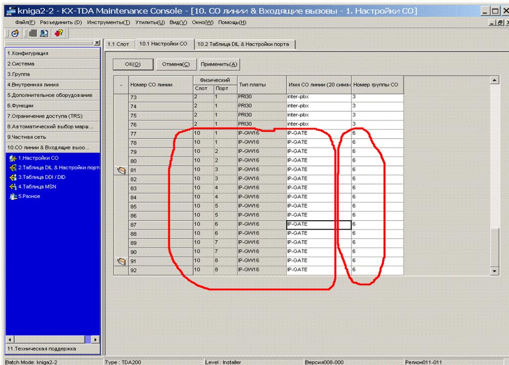
Видим, что добавилось 16 каналов транковых. Выделяем все 16 каналов в отдельную транковую группу (в нашем примере – в 6 транковую группу).
