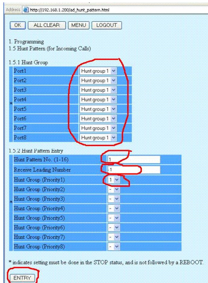
В графе Receive Leading Number в Киевском шлюзе прописываем цифру 2, в Минском шлюзе – цифру 3
