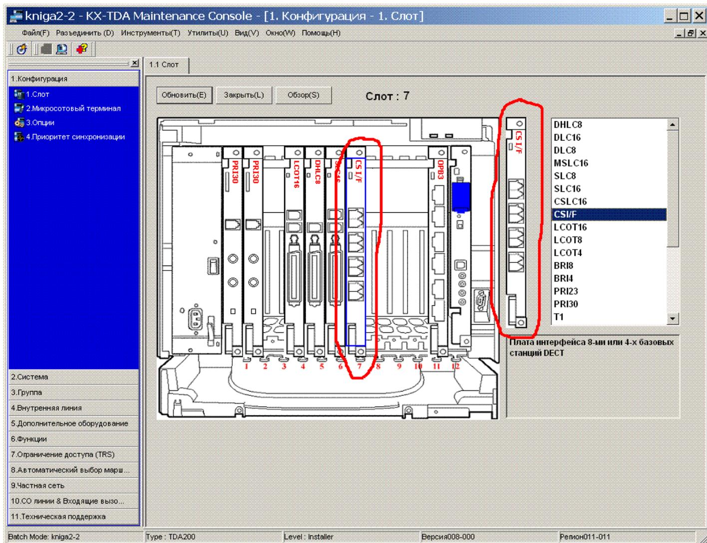
Подключите ваши базовые станции (в зависимости от их типа – либо к плате контроллера, либо к внутренним цифровым портам)
